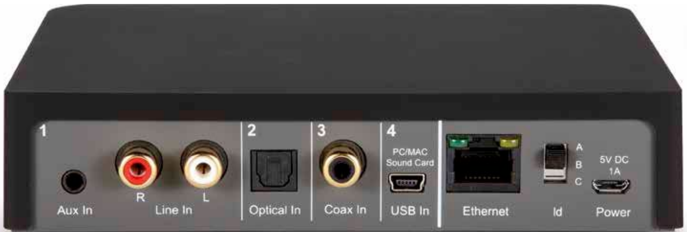
▲ Das „Hub“ genannte Verbindungskästchen zur Außenwelt bietet Analog- und Digitaleingänge, Schaltbarkeit für drei Zonen, Update-Möglichkeit per Ethernet-Anschluss, externes Netzteil.
