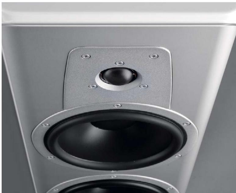
Die aufgesetzte Schallwand besteht aus bis zu 1 cm starkem Aluminium, das an den Seiten zur Vermeidung von Kantenreflexionen verrundet wurde. Die hochwertige Esotar-2-Kalotte sitzt in einem massiven Aluminiumblock und bleibt somit unbeeindruckt von den Bewegungen der Tiefmitteltöner.
