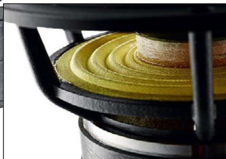
die Formgebung und den kleineren Schwingspulenansatz (5,5 statt 7,5 cm) nicht weniger stabil ist. Die entsprechend verkleinerte Schwingspule sitzt auf einem Glasfaserträger (früher aus Kapton), der entsprechend steifer ist und auch bei größeren Auslenkungen nicht zu Taumeln oder Verformungen neigt.
