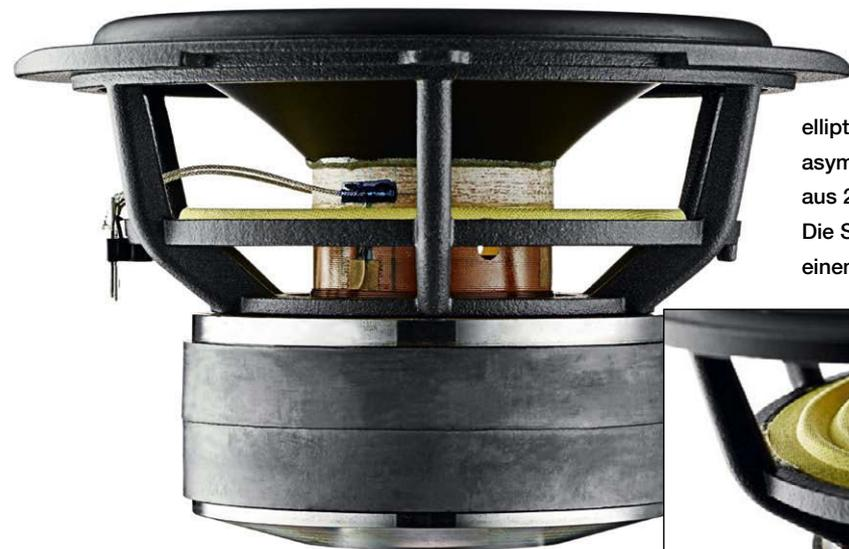
Das Genie im Detail: Der Konus besitzt eine elliptische Sicke und eine asymmetrisch gefaltete Spinne aus 2-Komponenten-Material. Die Schwingspule sitzt auf einem Glasfaserträger.
